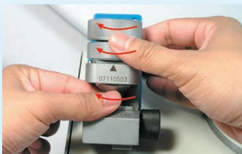
1. **Установите патрон с фрезой** в установочное гнездо и проверните по часовой стрелке до упора так, чтобы контрольная выемка на гайке была напротив установочной метки.
