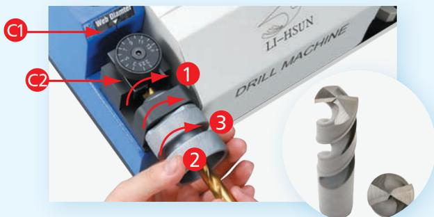
1. **Поверните круговую шкалу (C1)** по часовой стрелке до конца, далее поверните ее против часовой стрелки до показателя диаметра сверла, которое требует шлифовки.
