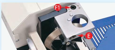
1. Для **увеличения угла** заточки вращайте винт F1 по часовой стрелке (+) – чтобы получить больший угол заточки, против часовой стрелки (-) – чтобы получить меньший угол заточки.
