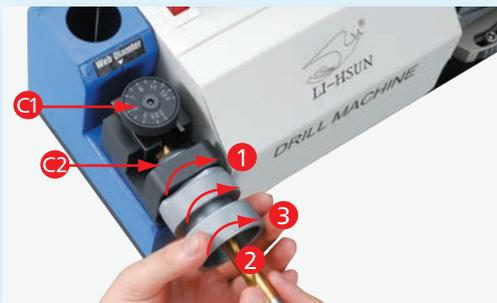
1. **Обнулите шкалу-рукоятку (C1)** путем поворота ее по часовой стрелке до упора или до нуля. Поверните против часовой стрелки до требуемой отметки на шкале, соответствующей диаметру сверла.
