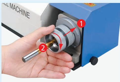
1. **Вставьте цанговый патрон** в гнездо для заточки (см. 1) так, чтобы грани выемки на цанговом зажиме уперлись в специальные шпильки гнезда и установите сверло в отверстие, но не упирайте сверло в алмазный круг.
